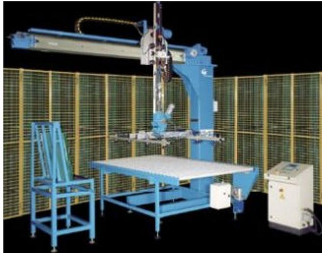
Caricatore automatico a comando elettromeccanico e pneumatico per il trasferimento di lastre di vetro dal carrello verticale al trasportatore orizzontale.
