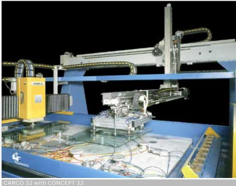
L'unità di carico/scarico tipo **CARCO** è in grado di trasferire lastre di vetro dal carrello verticale (pallet) alla zona di molatura orizzontale della macchina molatrice e successivamente da questa posizione ad un trasportatore orizzontale oppure ad un altro carrello verticale.
