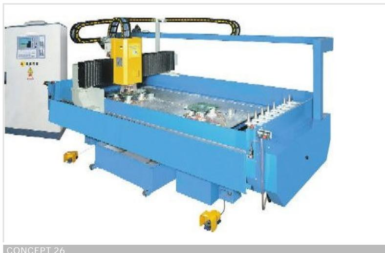
Macchina automatica a controllo numerico (CNC) per la molatura e la lucidatura del bordo su vetri sagomati con curve interne, curve esterne, lati rettilinei, spigoli vivi.
